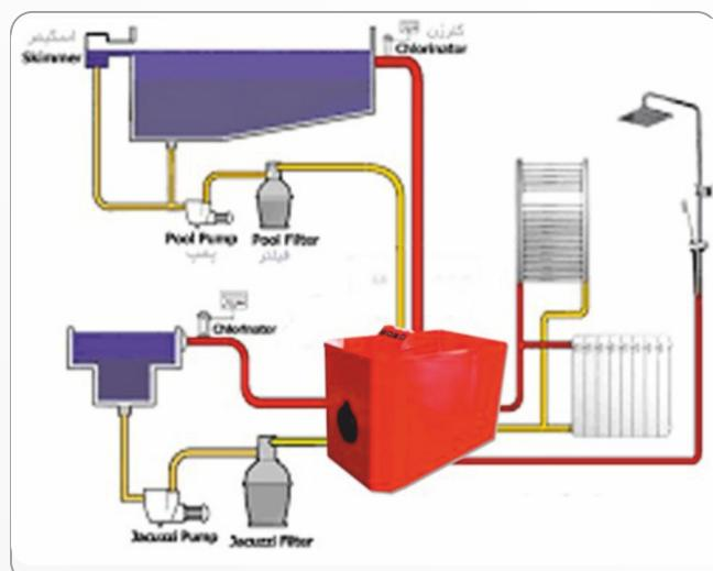
دیگ این پکیج‌ها از نوع چدن آتش خوار بوده و با ۳ پاس حرارتی و مجهز به توربولاتور راندمان بالایی دارد. علاوه بر داشتن انتقال حرارت مناسب مقاومت بسیار بالایی در برابر اکسید شدن و عوامل شیمیایی تاثیرگذار بر سطح دارد. آلیاژ مخصوص چدن در برابر عوامل محیطی مانند رطوبت محیط و مقاومت در برابر میزان حاصل از احتراق بسیار مناسب است.
